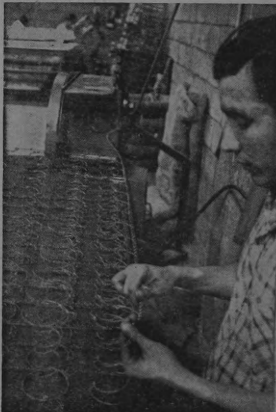
Forma en que se coloca la varilla lateral en los colchones para brindar mayor consistencia. El obrero José Contreras es el experto en este trabajo.
